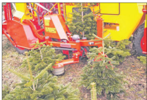
Stumpfbeschneider BP von Damcon, hier am Damcon-Portaltraktor.
