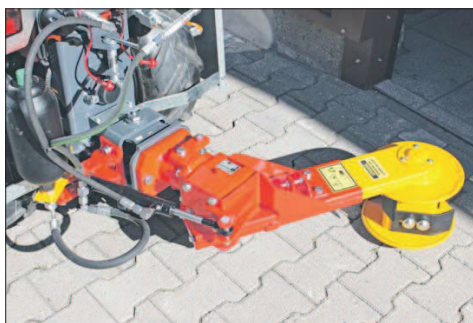
Stumpfbeschneider von Fort Sirio 4x4, montiert am Minitraktor.
